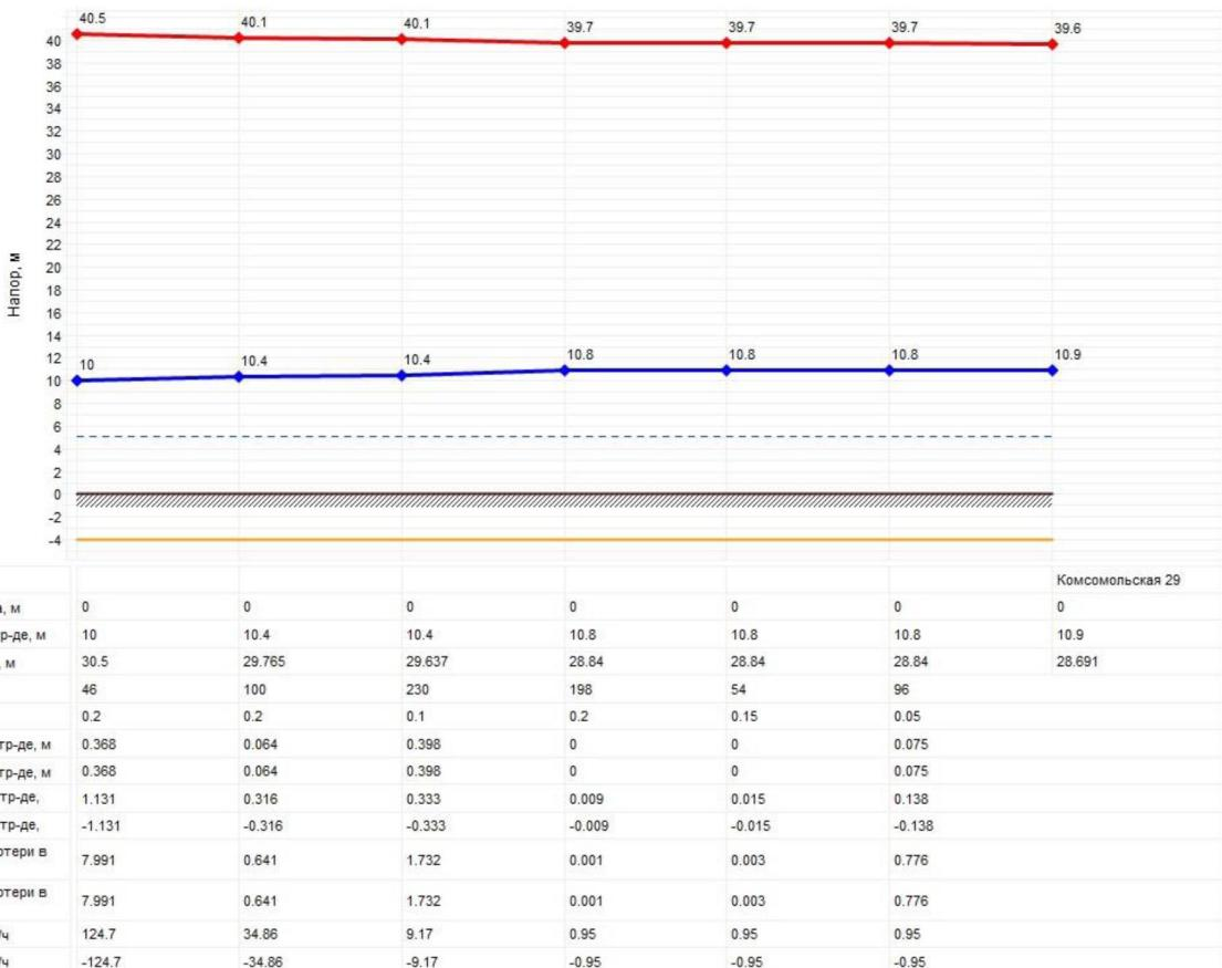
Рисунок 2.39 – Пьезометрический график от Котельной №2 с. Кичигино до самого удаленного потребителя в аварийной ситуации до ул. Комсомольская
