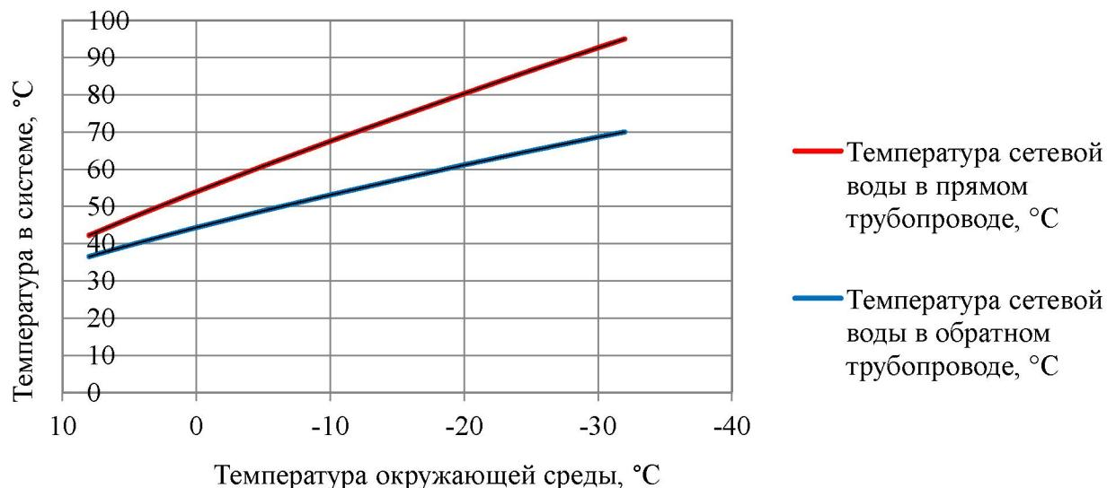
Рисунок 2.6 – График изменения температур теплоносителя 95–70 °C
