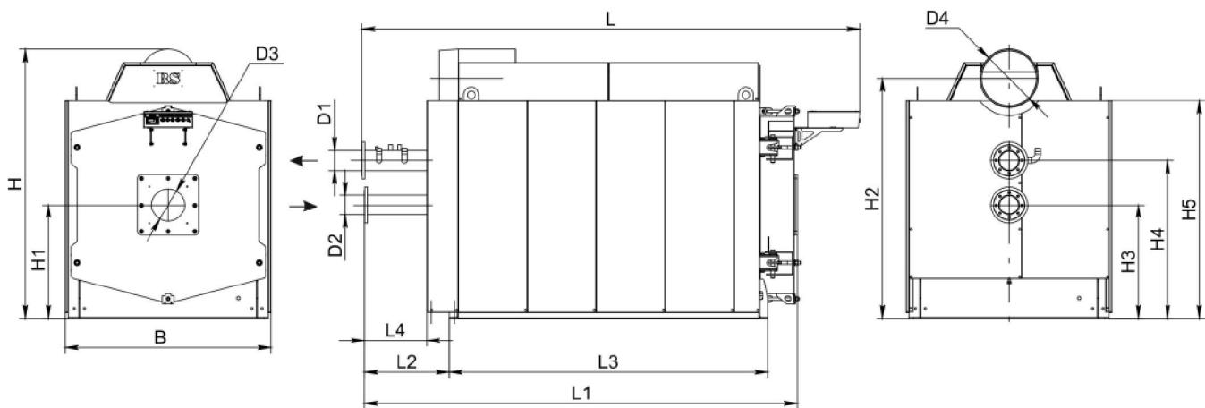
Рисунок 2.2 Габаритные и присоединительные размеры котла RS D-2000:
