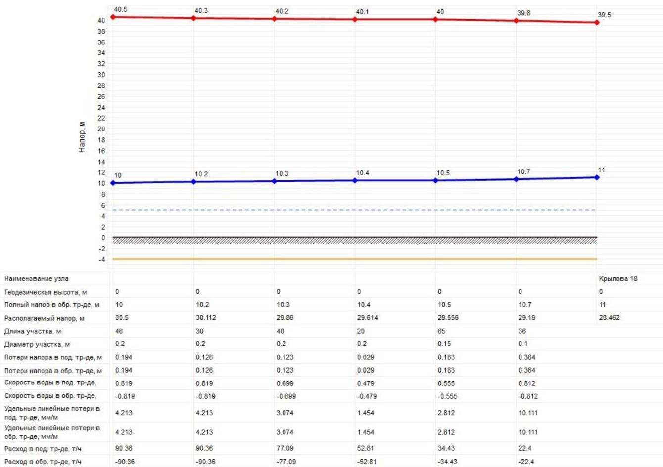
Рисунок 2.33 – Пьезометрический график от источника теплоснабжения (Котельной №2 с. Кичгино) до самого удаленного потребителя
