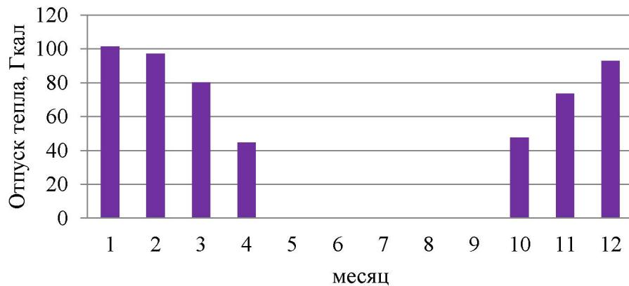
Рисунок 1.7 Оптимальный температурный график отпуска тепловой энергии для Котельной ТКУ-1000 с. Кичигино с температурным режимом 95-70 °C
