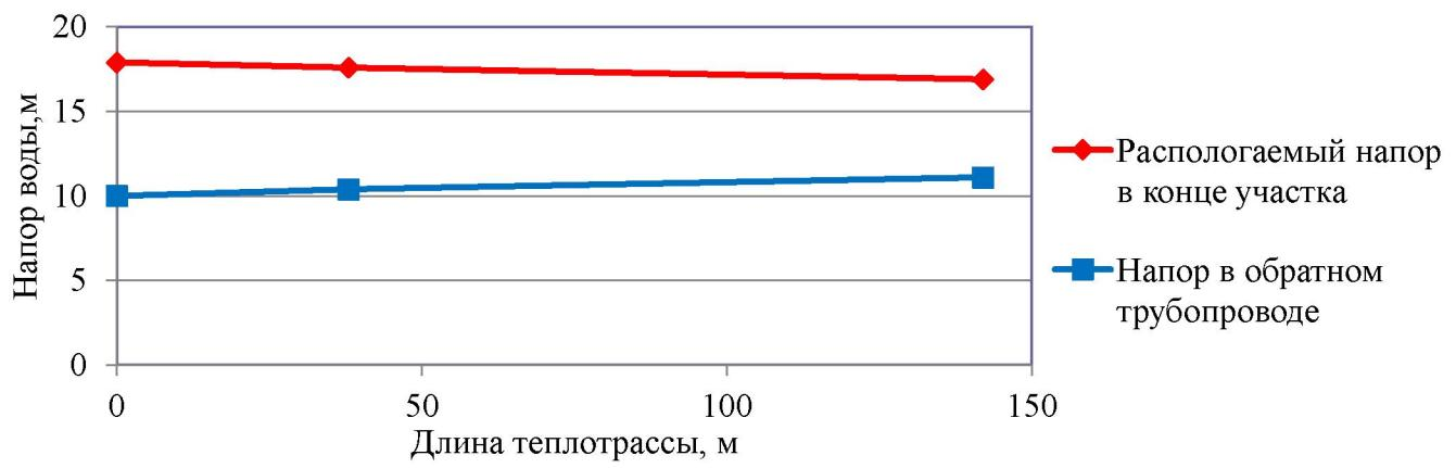
Рисунок 2.7 – Пьезометрический график тепловой сети Котельной №1 с. Кичигино
