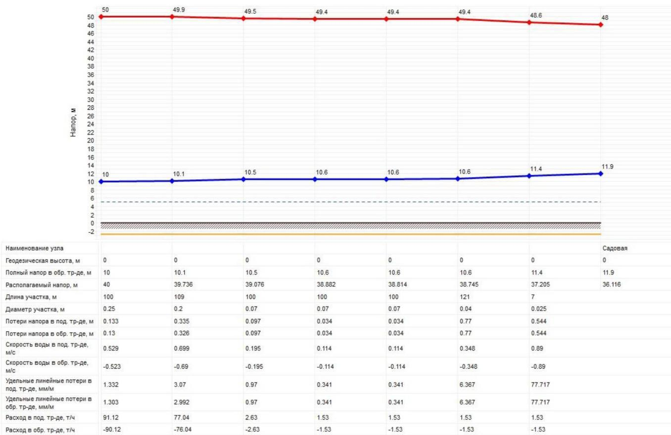
Рисунок 2.44 – Пьезометрический график от Котельной п. Нагорный до самого удаленного потребителя в аварийной ситуации по ул. Садовая
