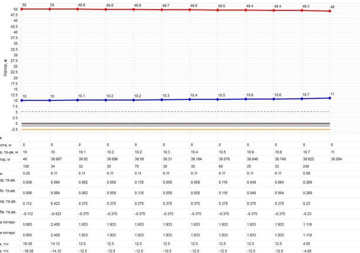
Рисунок 2.35 – Пьезометрический график от источника теплоснабжения (Котельной п. Нагорный) до самого удаленного потребителя – детского сада
