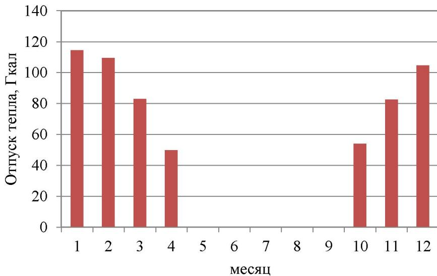
Рисунок 1.5 – Оптимальный температурный график отпуска тепловой энергии для Котельной №1 с. Кичигино с температурным режимом 85-64 °C
