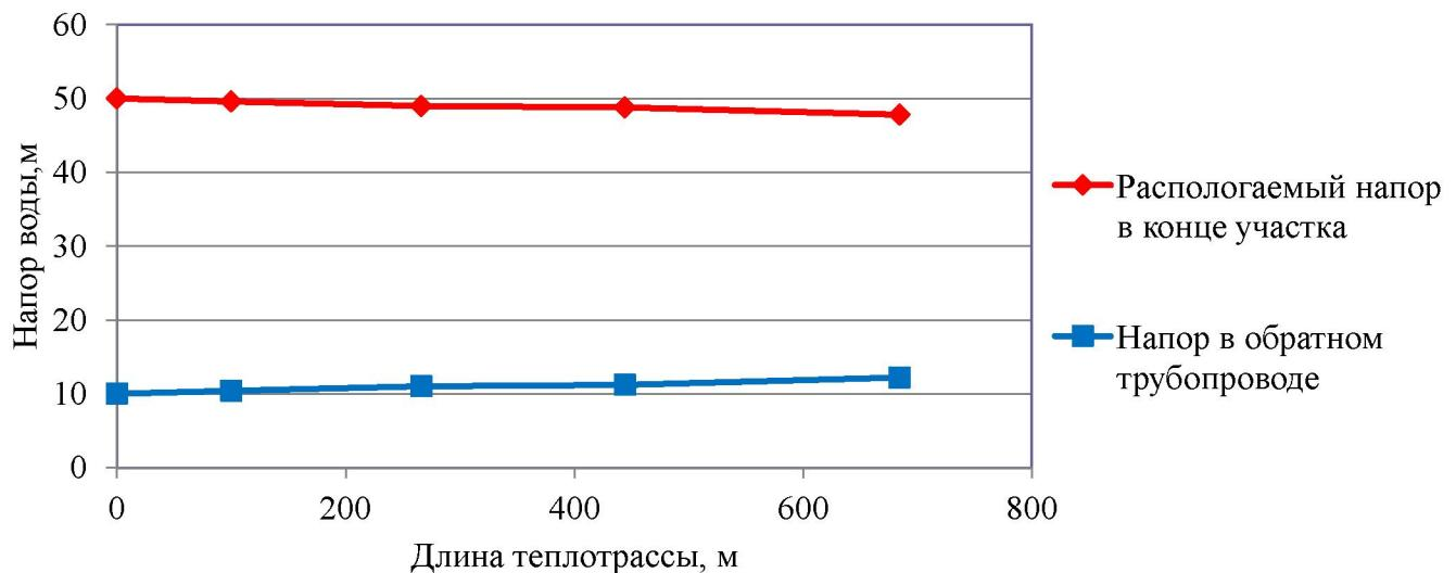
Рисунок 2.22 – Пьезометрический график тепловой сети Котельная п. Нагорный до детского сада
