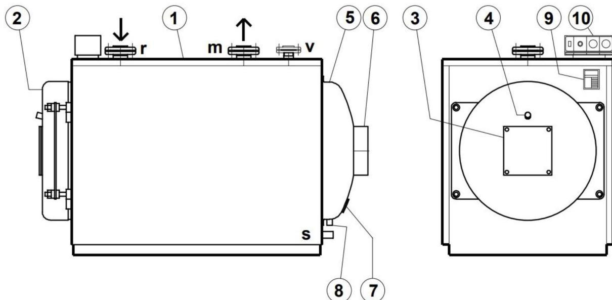
Рисунок 2.1 Устройство котла Super SUPER RAC-AR 230
