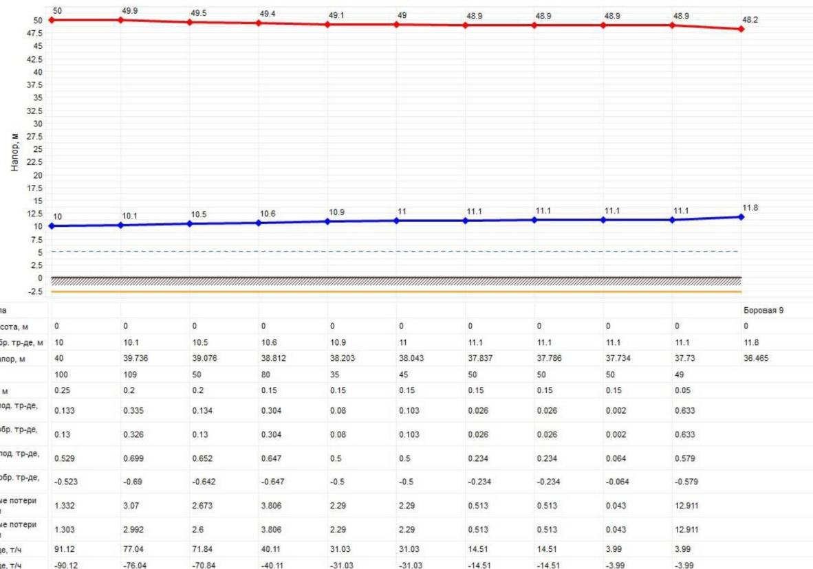
Рисунок 2.41 – Пьезометрический график от Котельной п. Нагорный до самого удаленного потребителя в аварийной ситуации по ул. Боровая
