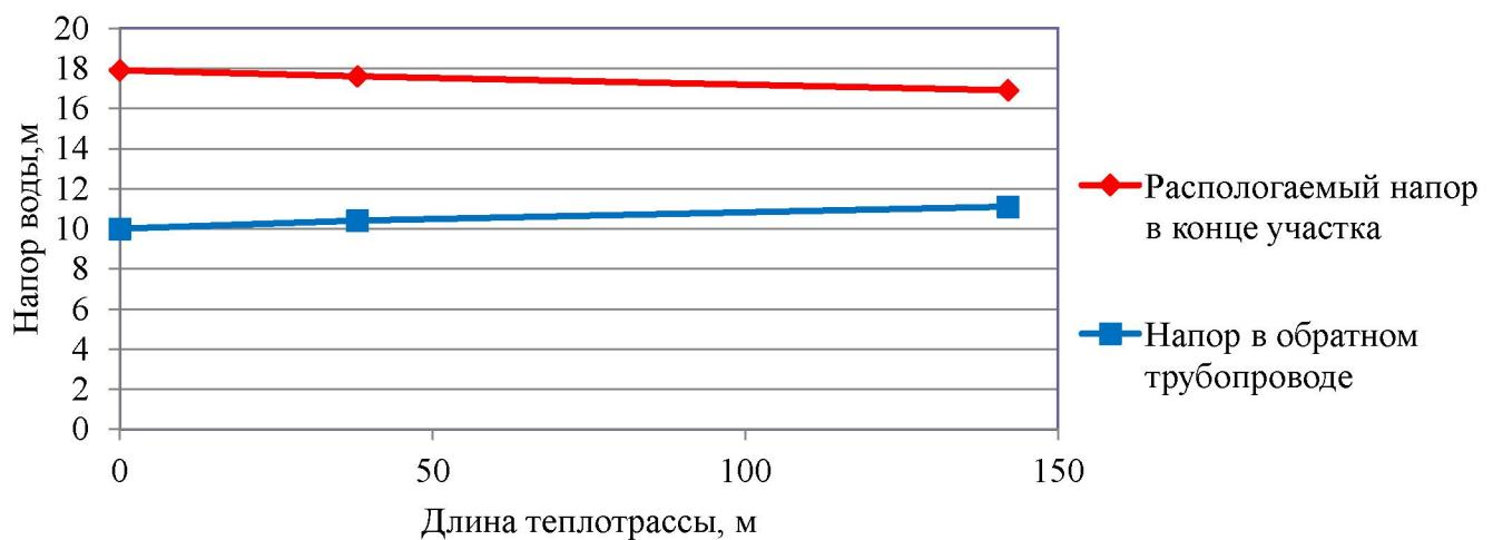
Рисунок 2.17 – Пьезометрический график тепловой сети Котельной №1 с. Кичигино
