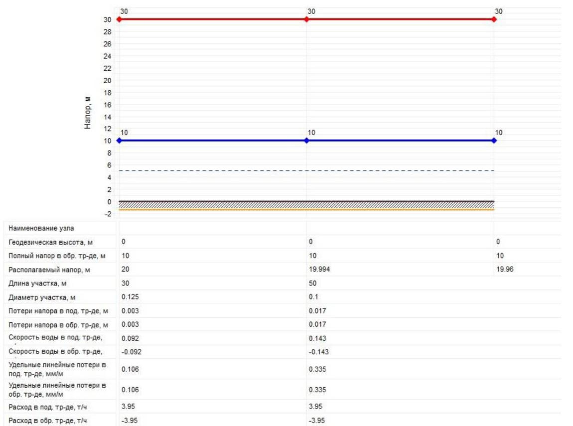
Рисунок 2.40 – Пьезометрический график от источника теплоснабжения (Котельной ТКУ-1 с. Кичгино) до самого удаленного потребителя в аварийной ситуации
