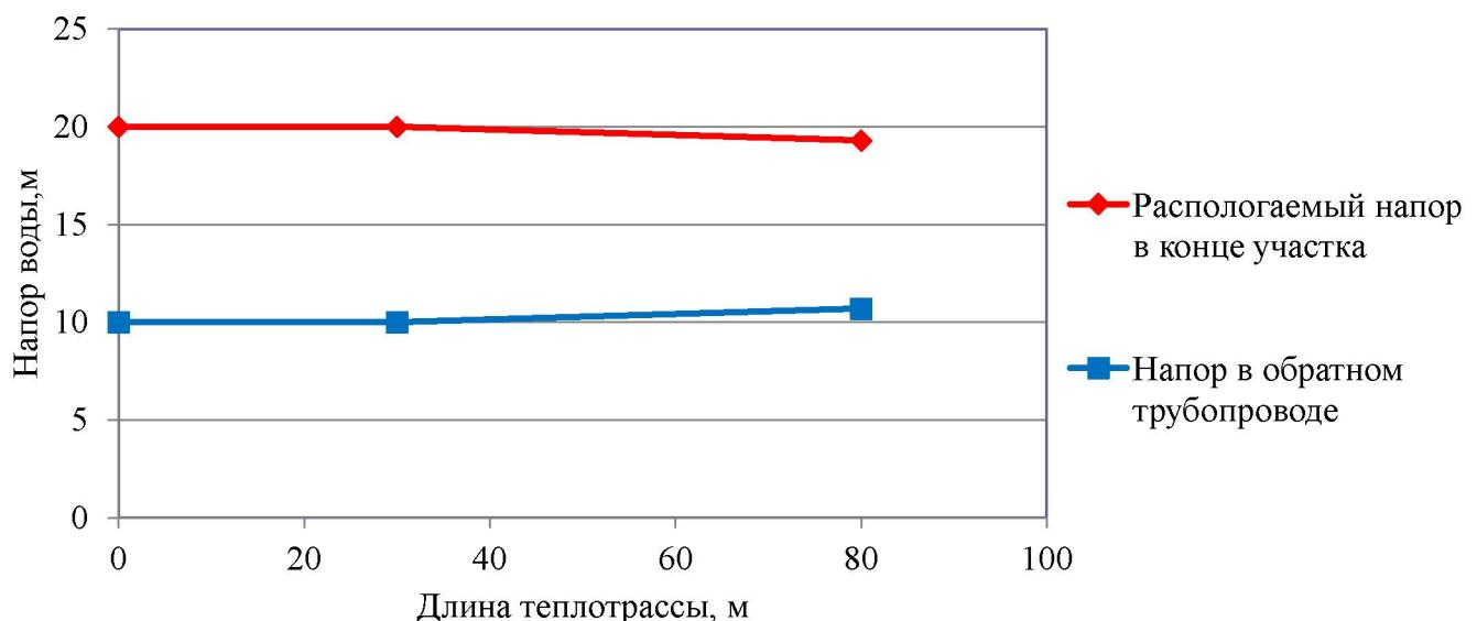
Рисунок 2.20 – Пьезометрический график тепловой сети Котельная ТКУ-1000 с. Кичгино
