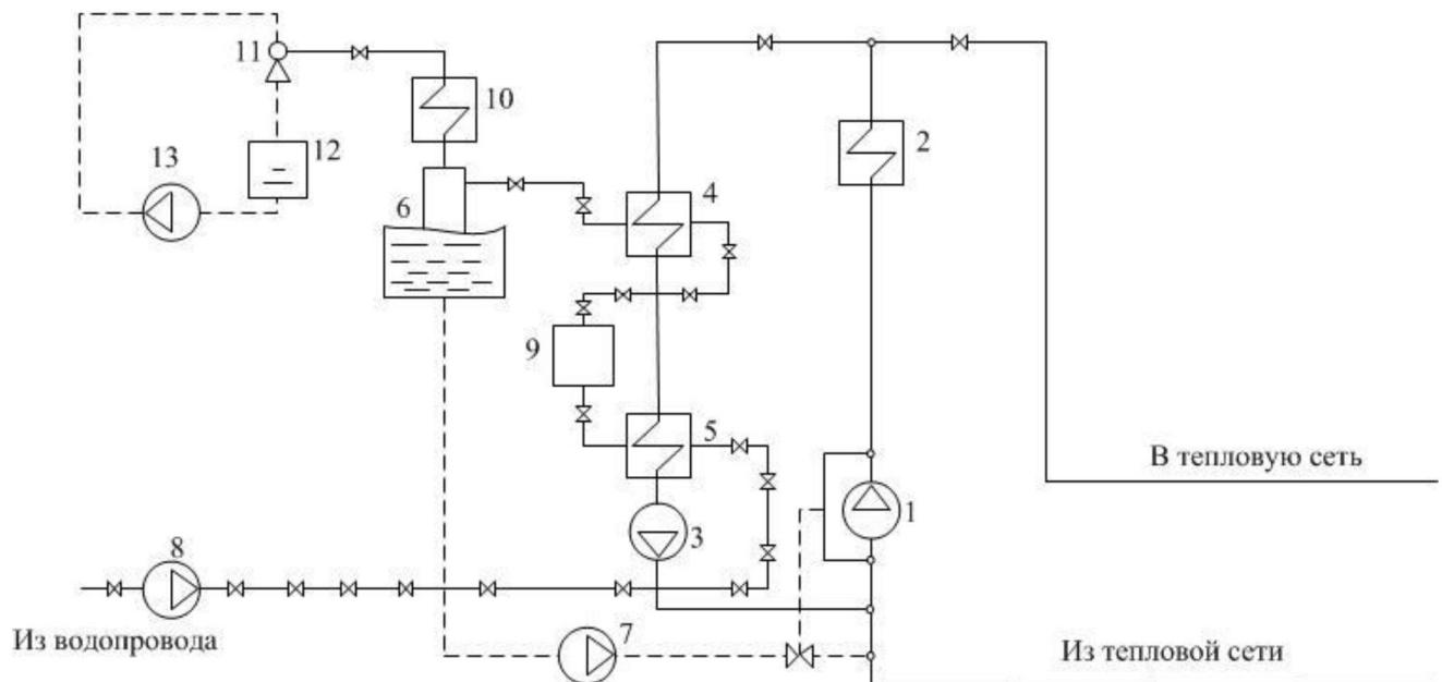
Рисунок 2.3 – Принципиальная тепловая схема котельной с водогрейными котлами:
