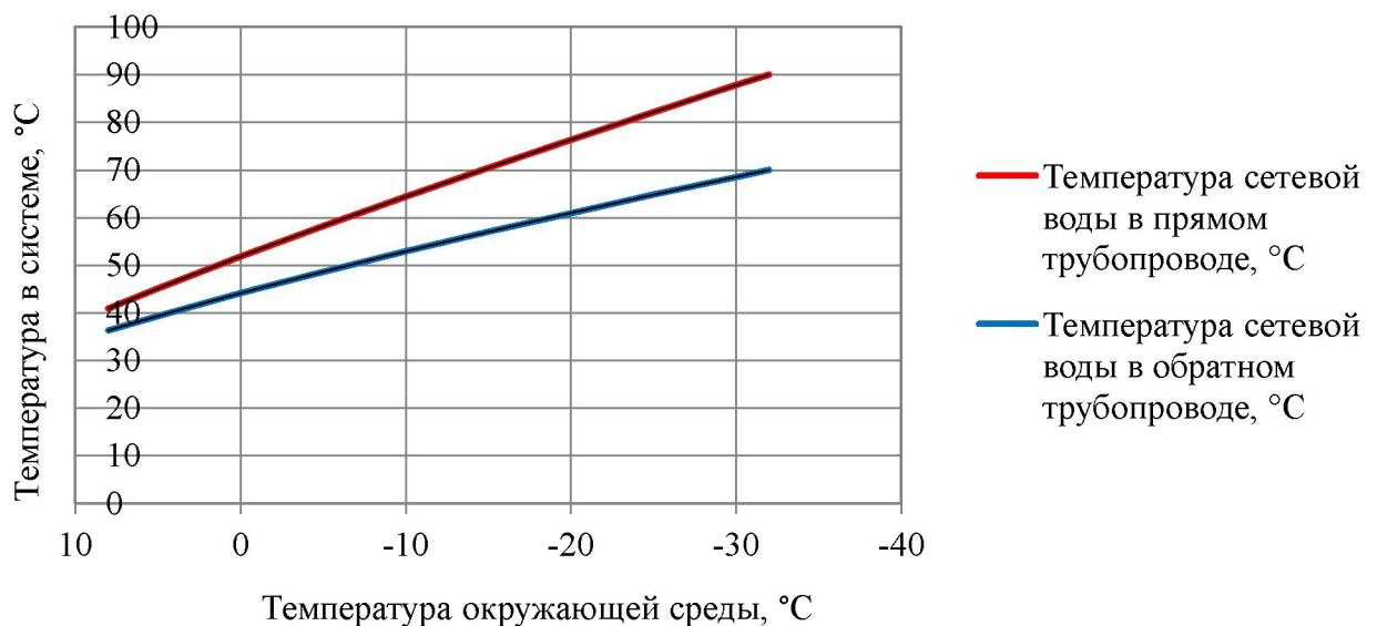
Рисунок 2.4 – График изменения температур теплоносителя 90–70 °C
