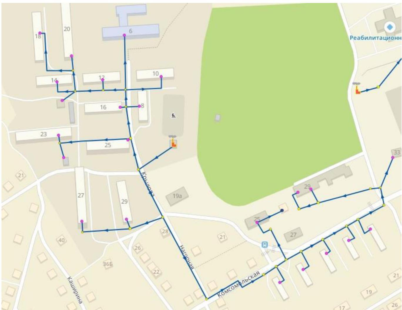
Рисунок 2.29 – Модель системы теплоснабжения Котельной №2 с. Кичигино
