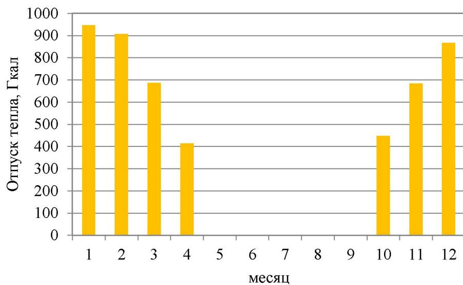
Рисунок 1.6 Оптимальный температурный график отпуска тепловой энергии для Котельная №2 с. Кичигино с температурным режимом 85-64 °C
