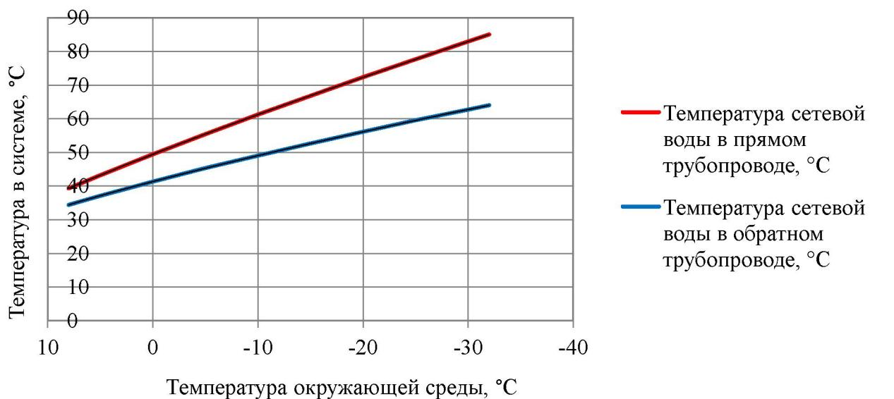
Рисунок 2.5 – График изменения температур теплоносителя 85–64 °C
