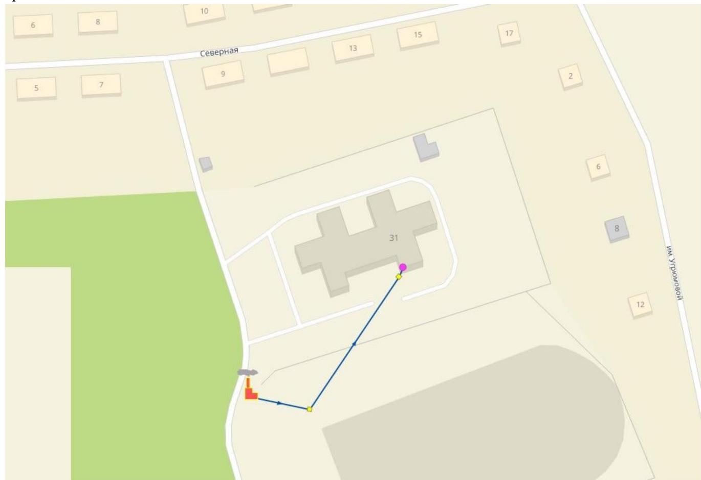
Рисунок 2.28 – Модель системы теплоснабжения Котельной №1 с. Кичгино
