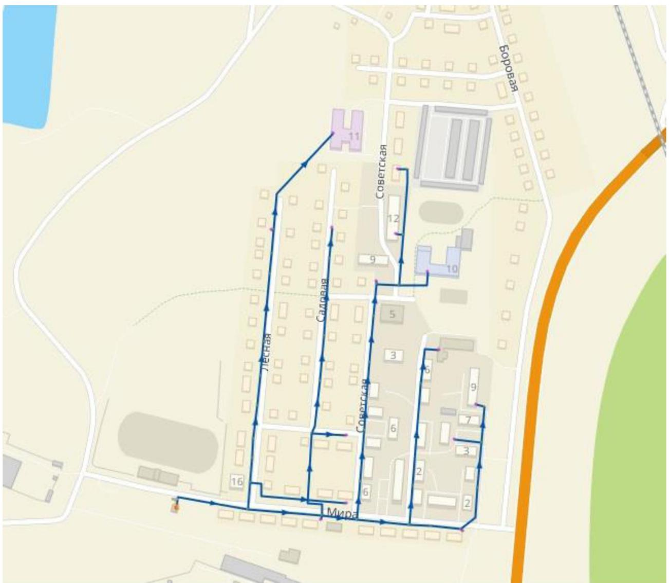
Рисунок 2.31 – Модель системы теплоснабжения Котельной п. Нагорный
