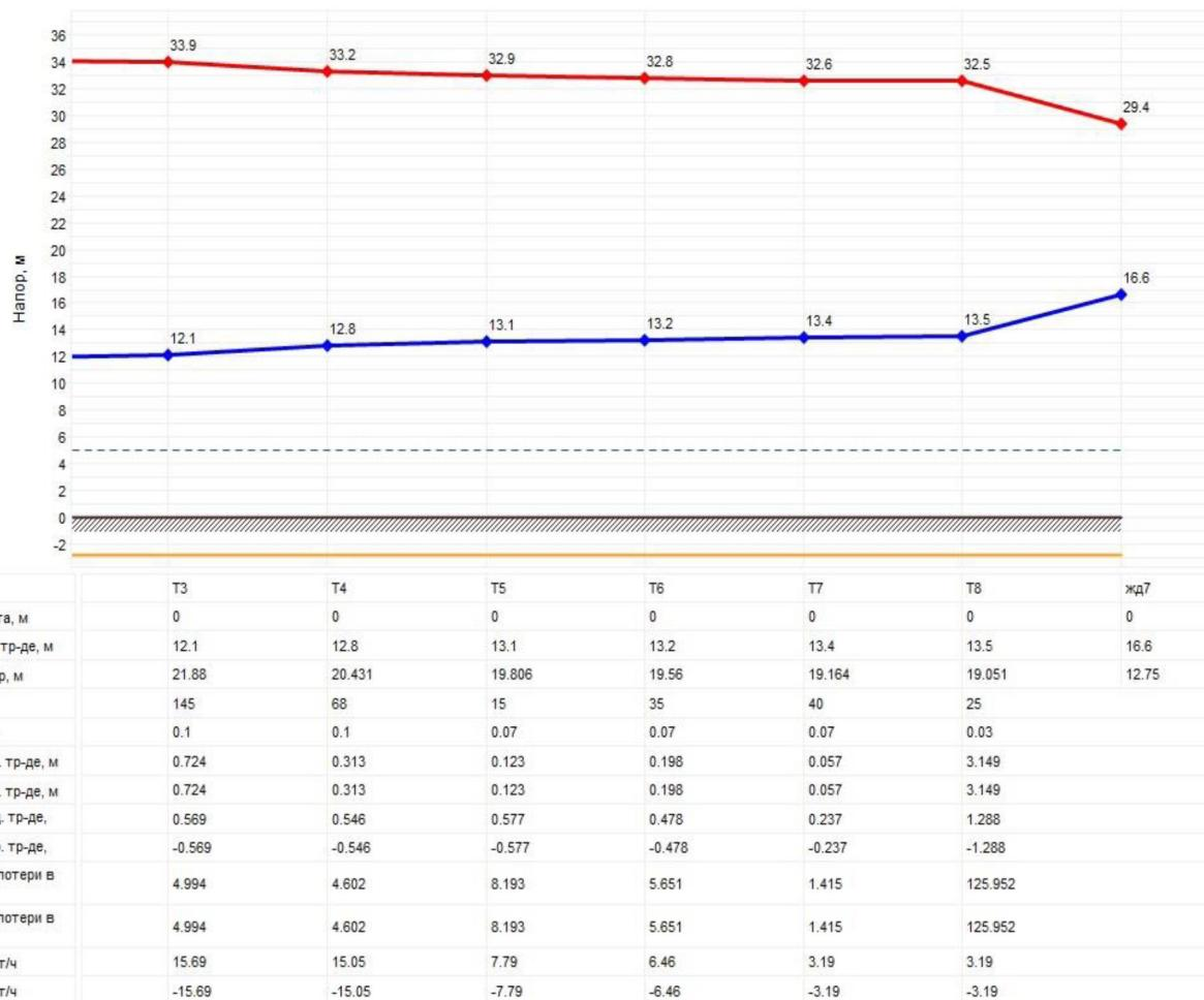
Рисунок 2.46 – Пьезометрический график от источника теплоснабжения (Котельной п. Синий Бор) до самого удаленного потребителя в аварийной ситуации
