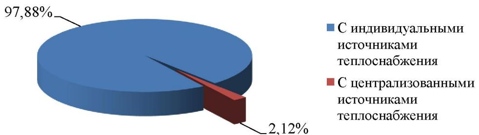
Рисунок 1.3 – Соотношение общей площади п. Синий Бор и площади охвата централизованной системы теплоснабжения п. Синий Бор
