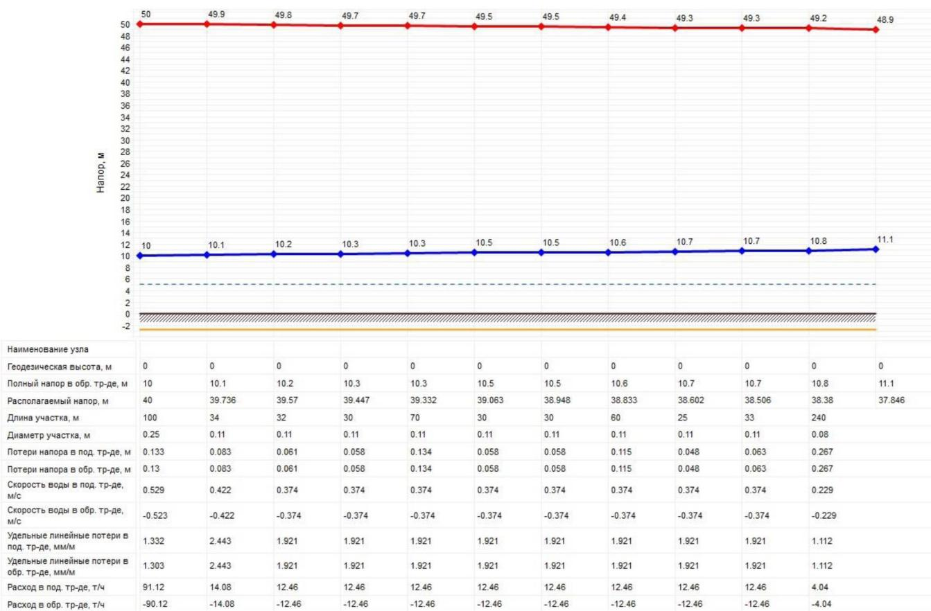
Рисунок 2.42 Пьезометрический график от Котельной п. Нагорный до самого удаленного потребителя в аварийной ситуации здания детского сада
