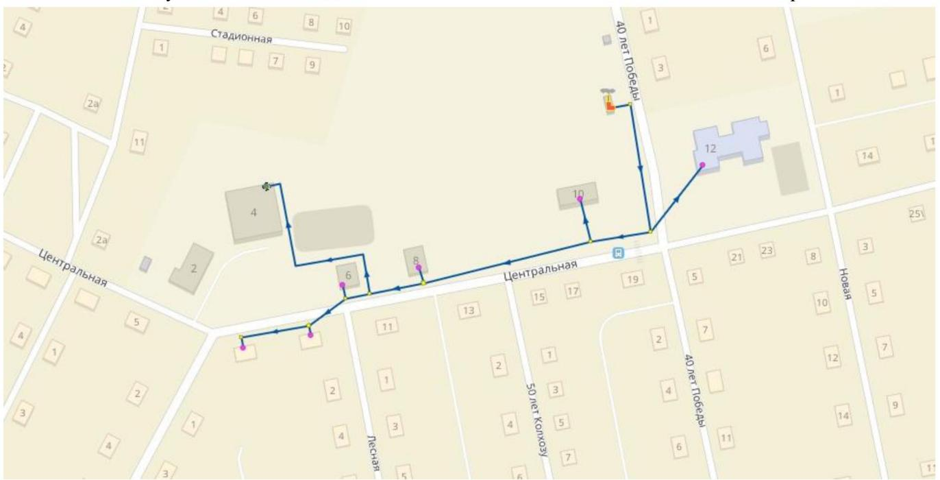
Рисунок 2.32 – Модель системы теплоснабжения Котельной п. Синий Бор
