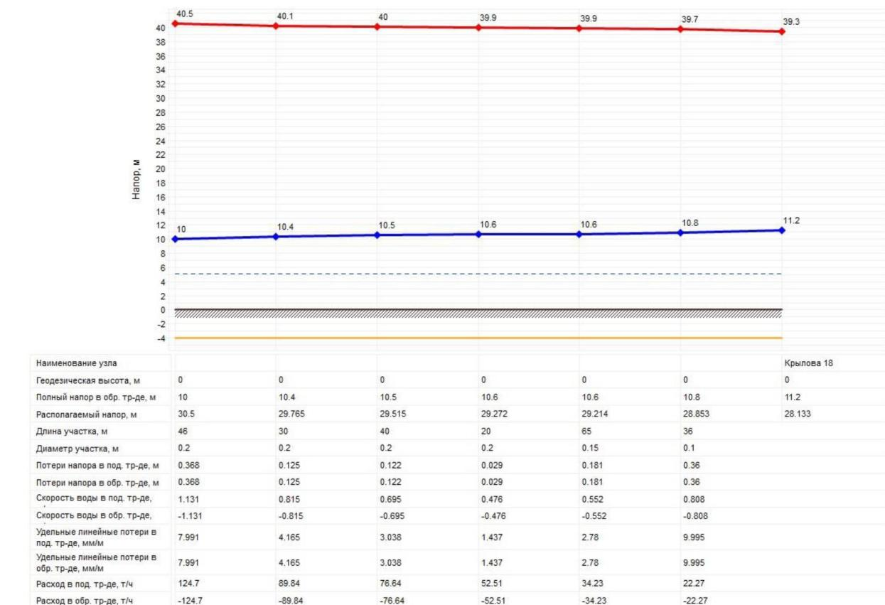
Рисунок 2.38 – Пьезометрический график от Котельной №2 с. Кичигино до самого удаленного потребителя в аварийной ситуации до ул. Крылова 18
